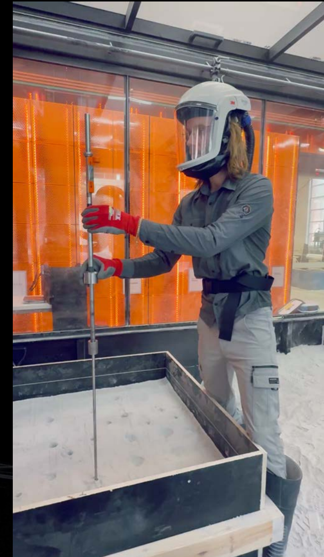
Mini dynamic cone penetrometer (Mini-DCP)
